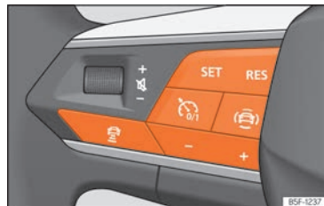
Sl. 106 Na višenamjenskom kolu upravljača: tipke za rukovanje ACC-om.
