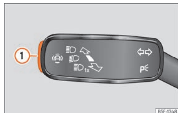
Sl. 95 Na ručici za žmigavce i duga svjetla: tipka sustava potpore za vozača (ovisno o modelu).
