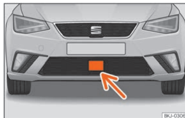
Sl. 97 U prednjem braniku: radarski senzor.
