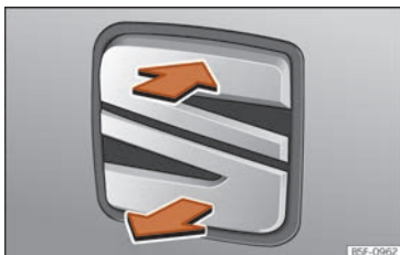
Sl. 58 Stražnji poklopac: otvaranje izvana
