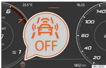
SL. 112 Na zaslonu kombiniranog instrumenta: prikaz da je Front Assist isključen.
