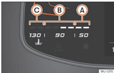
Sl. 8 Digitalni kombinirani instrument Basic Pokazivač temperature rashladnog sredstva motora.
