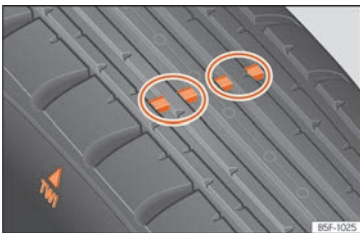
SL. 182 Profil gume: pokazivači istrošenosti.
