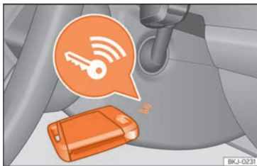
Sl. 87 Desno na stupu upravljača: pokretanje u nuždi.
