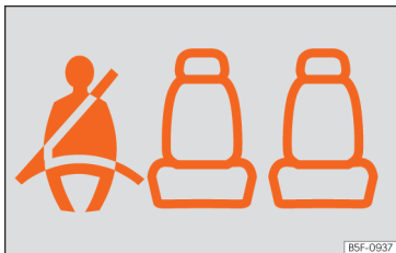
Sl. 21 Kombinirani instrument: prikaz statusa vezanja pojasa za stražnja mjesta za sjedenje.
