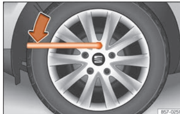
Sl. 189 Zamjena kotača: otpuštanje vijaka kotača
