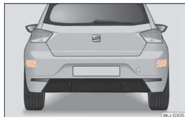
Sl. 100 Područje iza vozila; područja radarskih senzora.
