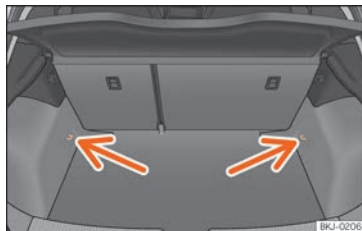
Sl. 141 Raspored ušica za vezanje prtljage u prtljažniku.
