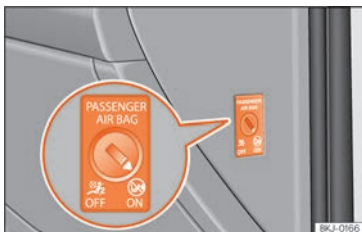
Sl. 30 Bravica za uključivanje i isključivanje suvozačevog zračnog jastuka.
