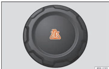
Sl. 173 Prednji prostor: poklopac kompenzacijskog spremnika rashladnog sredstva.
