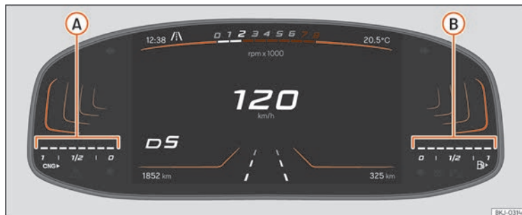
Sl. 7 Kombinirani instrument: Pokazivač zalihe zemnog plina
