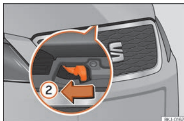
Sl. 171 Ručica ispod poklopca prostora motora.
