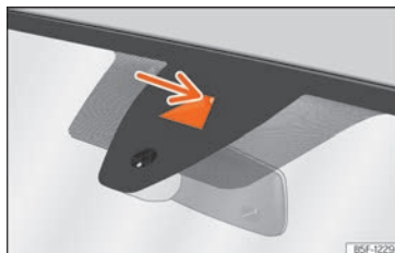
Sl. 99 Vidno polje kamere za potporu zadržavanja vozila na voznom traku.
