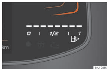
Sl. 5 Kombinirani instrument Basic: pokazivač zalihe goriva.
