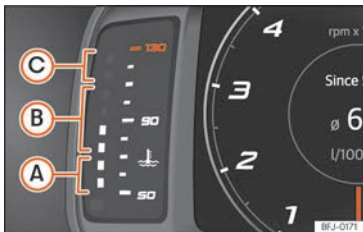
Sl. 9 Digitalni kombinirani instrument SEAT Digital Cockpit: Pokazivač temperature rashladnog sredstva motora.
