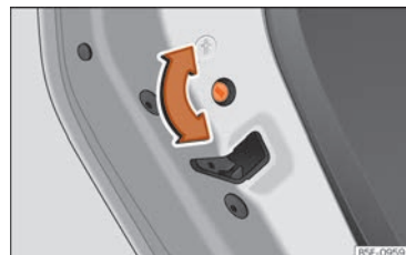
Sl. 57 Osigurač za djecu u lijevim vratima
