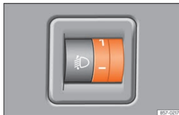
SL. 75 Pored kola upravljača: regulator za regulaciju visine svjetlosnog snopa.
