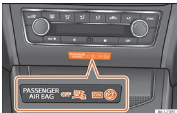
Sl. 31 Srednji dio instrumentne ploče: kontrolna žaruljica za isključeni suvozačev prednji zračni jastuk.
