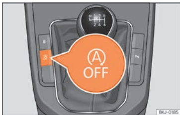
Sl. 88 Središnja konzola: Sistemska tipka start-stop.
