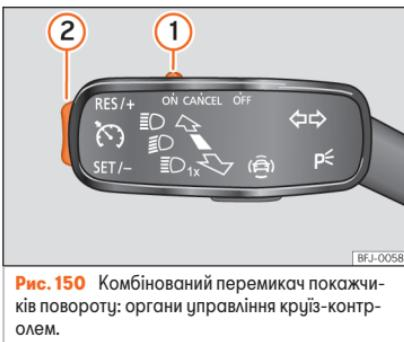
**Рис. 150** Комбінований перемикач покажчиків повороту: органи управління круїз-контролем.
