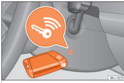
**Рис. 138** Праворуч від керма: аварійний пуск двигуна.
