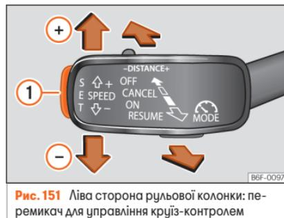
**Рис. 151** Ліва сторона рульової колонки: перемикач для управління круїз-контролем
