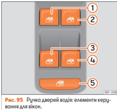
**Рис. 95** Ручка дверей водія: елементи керування для вікон.
