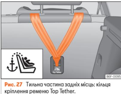
**Рис. 27** Тильна частина задніх місць: кільце кріплення ременю Top Tether.
