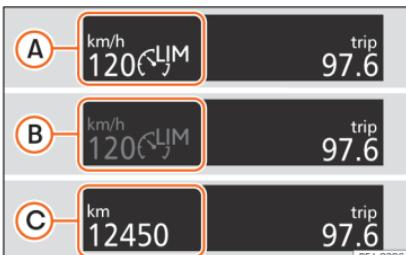
**Рис. 152** Дисплей комбінації приладів: індикатори стану обмежувача швидкості.
