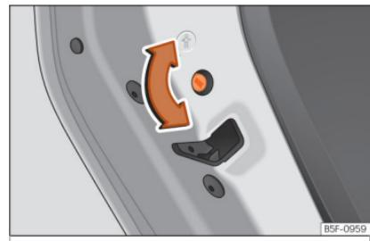
**Рис. 92** Дитячий замок лівих задніх дверей
