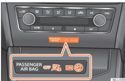
Рис. 17 Центральна частина панелі приладів: індикатор відключення подушки безпеки пасажира.
