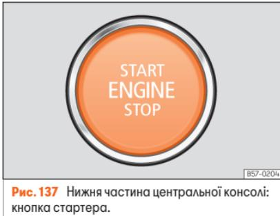
**Рис. 137** Нижня частина центральної консолі: кнопка стартера.
