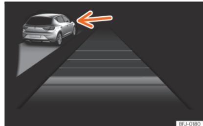
**Рис. 160** Дисплей комбінації приладів: АСС активний, виявлено автомобіль ліворуч
