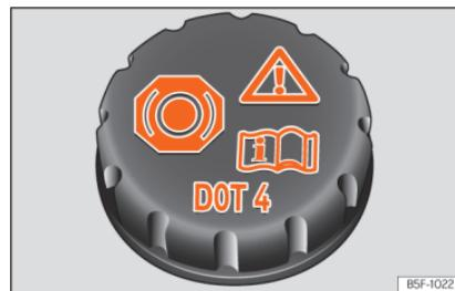
**Рис. 190** Моторний відсік: кришка бачка для гальмівної рідини.
