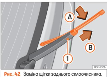
**Рис. 42** Заміна щітки заднього скоюочисника.
