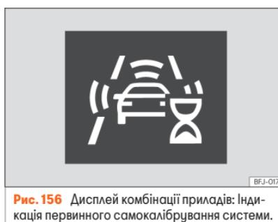
**Рис. 156** Дисплей комбінації приладів: Індикація первинного самокалібрування системи.
