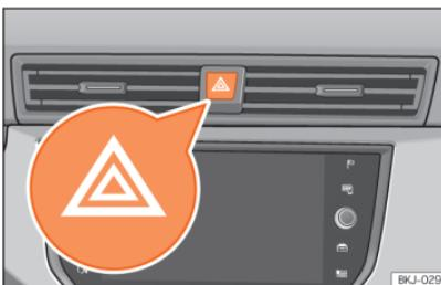
**Рис. 101** Передня панель: вимикач аварійної світлової сигналізації.
