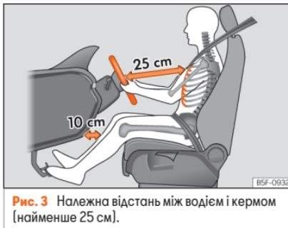
**Рис. 3** Належна відстань між водієм і кермом (найменше 25 см).
