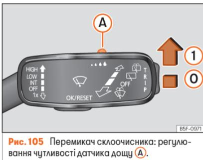
Рис. 105 Перемикач склоочисника: регулювання чутливості датчика дощу А.
