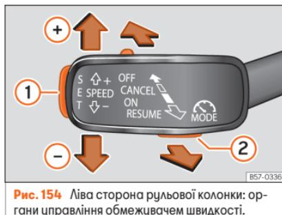
Рис. 154 Ліва сторона рульової колонки: органи управління обмежувачем швидкості.
