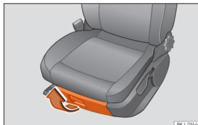
**Рис. 123** Відділення для речей під сидінням переднього пасажира
