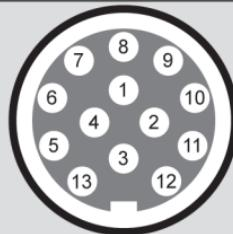
**Рис. 168** Схематичний вигляд: призначення контактів електричного роз'єму для підключення причепа.
