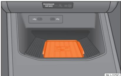
**Рис. 134** На центральній консолі: гнізда для під'єднання мобільного телефону.
