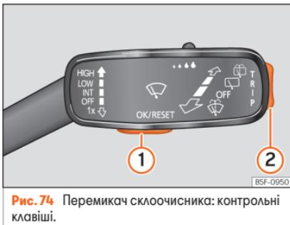
**Рис. 74** Перемикач склоочисника: контрольні клавіші.
