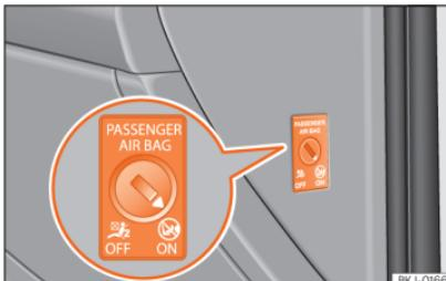
Рис. 16 Вимикач для відключення й підключення фронтальної подушки безпеки пасажира.
