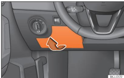
**Рис. 49** На панелі пристрій з боку водія: кришка блоку запобіжників.
