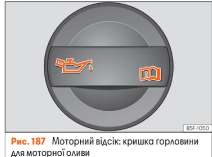
**Рис. 187** Моторний відсік: кришка горловини для моторної оліви
