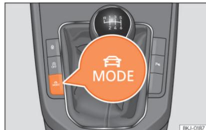
**Рис. 145** Поруч із важелем селектора: Клавіша вибору профілю (MODE).
