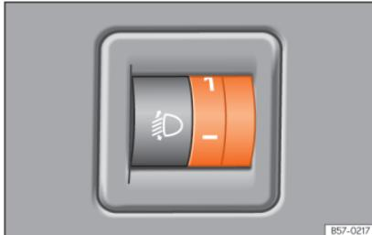
Рис. 102 Поруч з кермом: Коректор фар.
