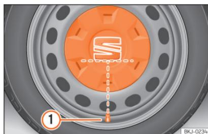
**Рис. 32** Правильне положення малорозмірного ковпака (сталевий диск).
