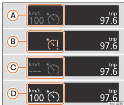
Рис. 149 Дисплей комбінації приладів: Індикатори стану круїз-контролю.
