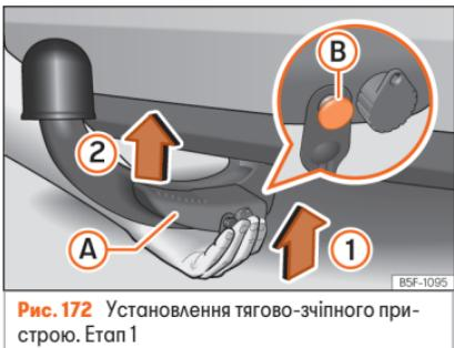
Рис. 172 Установлення тягово-зчіпного пристрою. Етап 1
